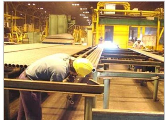
Ensayo visual posterior a la fabricación de tubos
