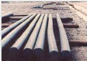
Las barras coladas presentan una curvatura que excede la especificación requerida por el laminador en caliente. Esto fue ocasionado por irregularidades en el proceso de enfriamiento.
