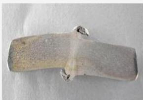
La imagen muestra el perfil de un área soldada con exceso de material expulsado en la costura. Una razón posible de esto es el desplazamiento de la chapa en el área de conformado. Se puede amolar.
