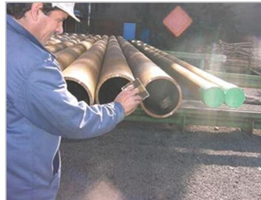
Ensayo visual posterior a la fabricación de tubos
