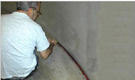
Aplicación de un líquido penetrante
